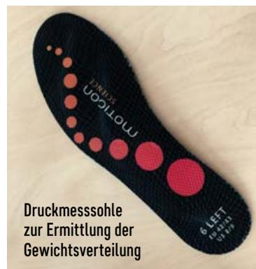
Druckmesssohle zur Ermittlung der Gewichtsverteilung
